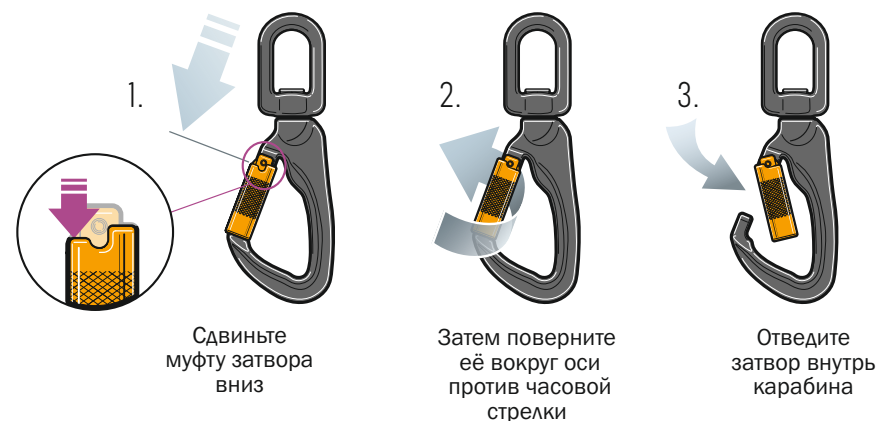
Рис. 3 Принцип работы карабина класса Т.
