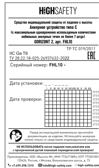
Рис. 3 Маркировка информационной таблички анкерной линии GORIZONT 2.
