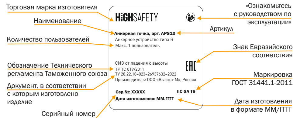
Рис. 1 Маркировка анкерной точки APS10.
